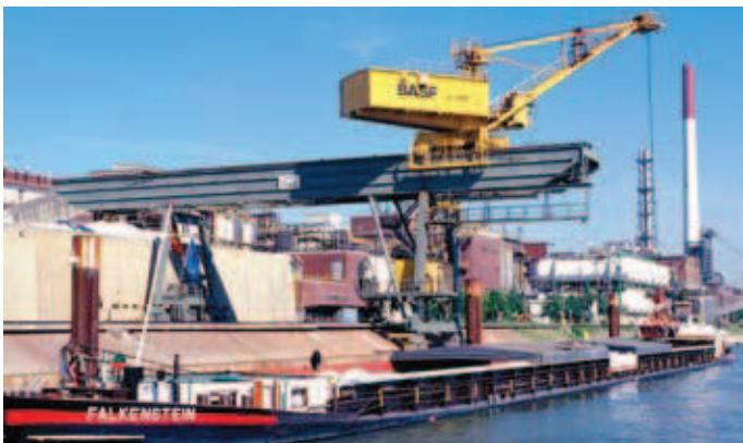
Salzentladung bei der BASF in Ludwigshafen
